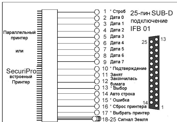
Рис. 5 SUB-D подключение для IFB 01
