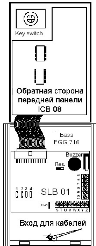
Рис. 3 Конфигурация KIM 731 и FGG 716
